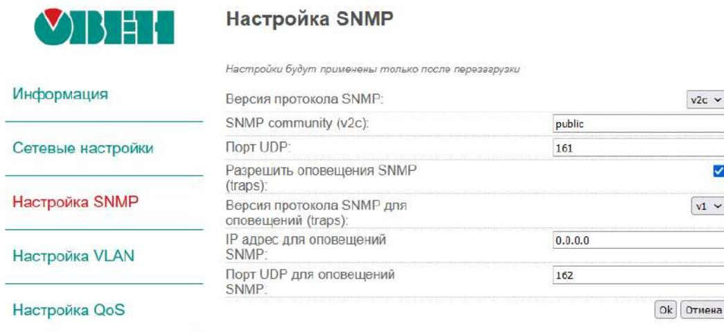
**Рисунок 7.10 – Раздел «Настройка SNMP»: 1) список выбора версии протокола SNMP**
