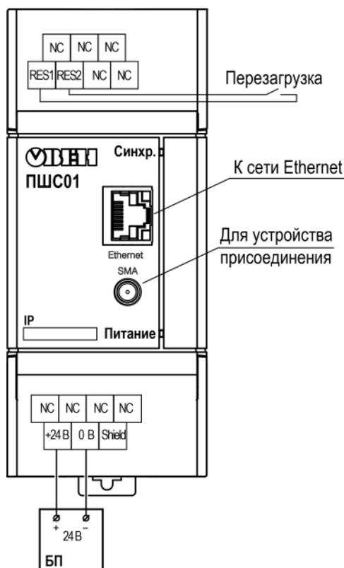
Рисунок 5.2 – Схема подключения
