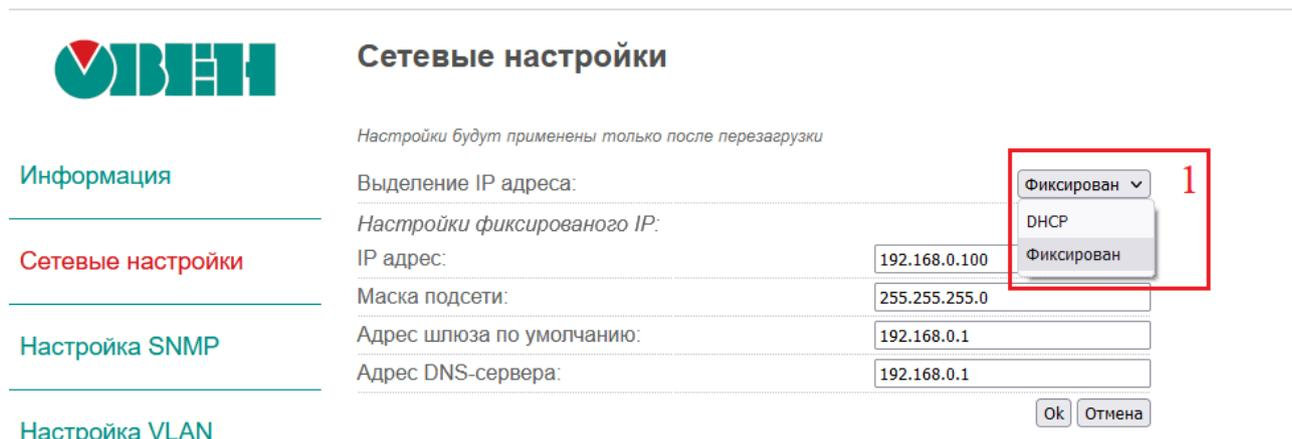
Рисунок 7.5 – Раздел «Сетевые настройки»: 1) список выбора режимов задания IP-адреса прибора
