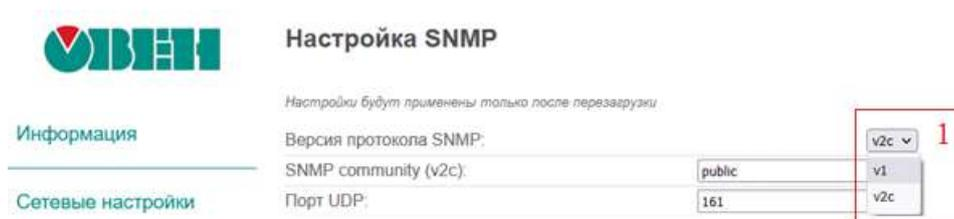
**Рисунок 7.9 – Раздел «Настройка SNMP»: 1) список выбора версии протокола SNMP**
